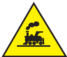
Cruce ferroviario con o sin barreras
