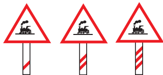
Cruce ferroviario a 100, 200 y 300 metros
