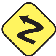
Curva y contracurva muy cerrada
